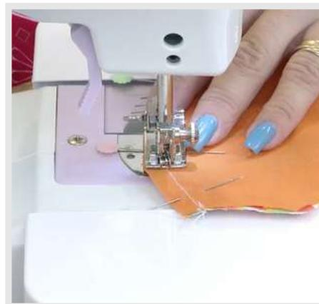
**12.** Passe uma costura à máquina na lateral alfinetada.
