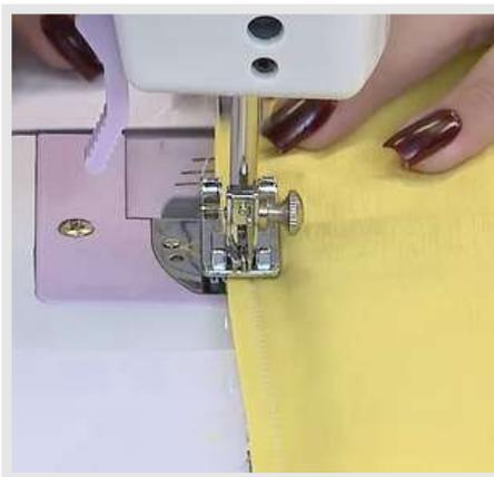
**08.** Utilize o ponto 4 da máquina e desloque a agulha para a esquerda.
